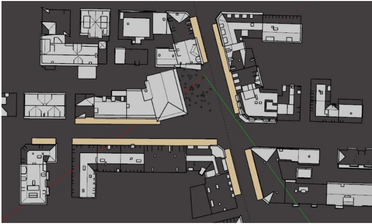
Abbildung 55: Sicht von Oben mit den eingebrachten Schallschuttschirmen.
