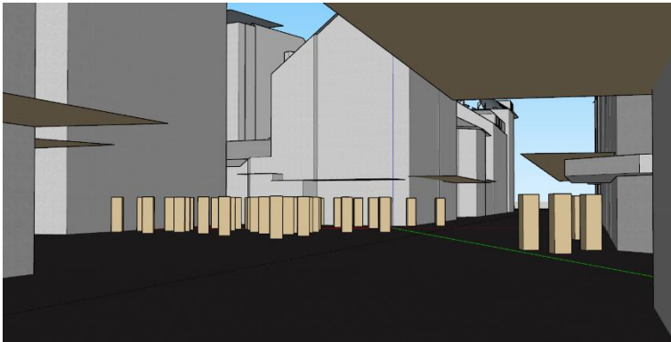
Abbildung 54: Sicht vom Gehsteig mit den eingebrachten Schallschuttschirmen.
