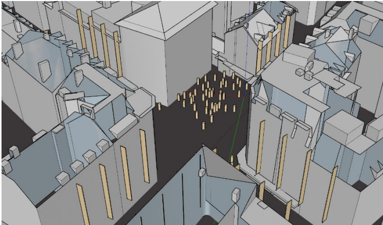
Abbildung 41: Absorbierende Elemente an den Fassaden.
